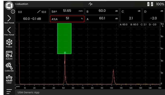
El USM 100 calcula los valores de las variables de AWS **C** y **D**, que pueden mostrarse en la línea de medición.
