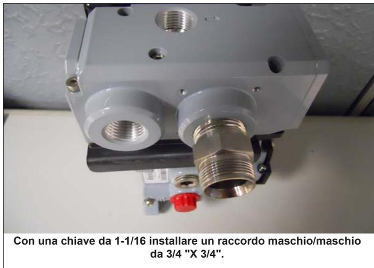
Figura 68 - Fase 1 Installazione di un raccordo 3/4" x 3/4"
