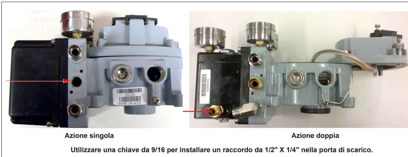
Figura 66 - Fase 2 Installazione di un raccordo da 1/2" x 1/4"
