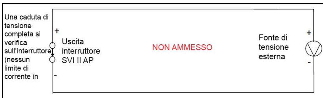
**Figura 49 - Disegno di installazione dell'interruttore senza carico: Configurazione non consentita**
