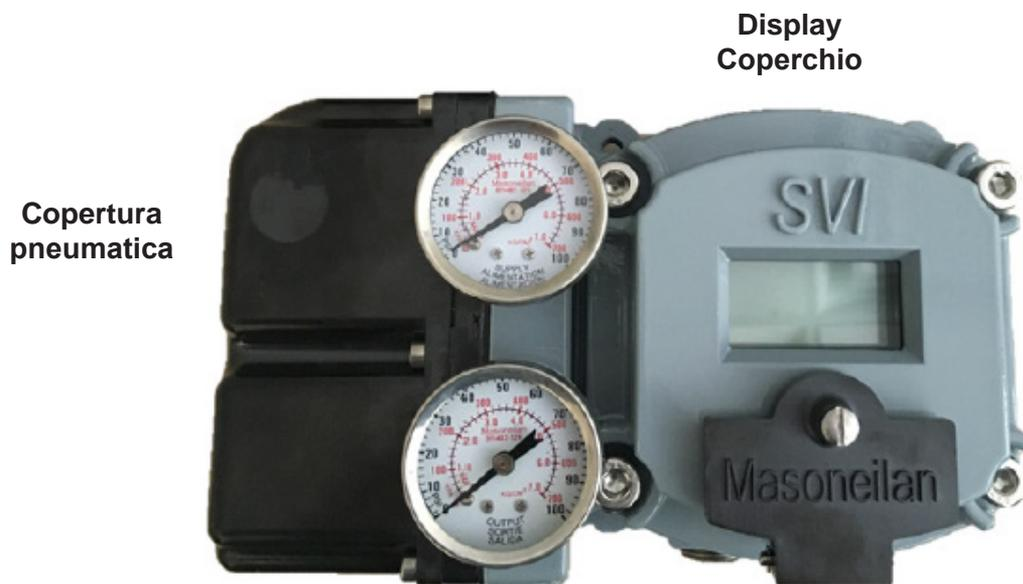
**Figura 57 - Display SVI II AP e coperchi dei componenti pneumatici**
