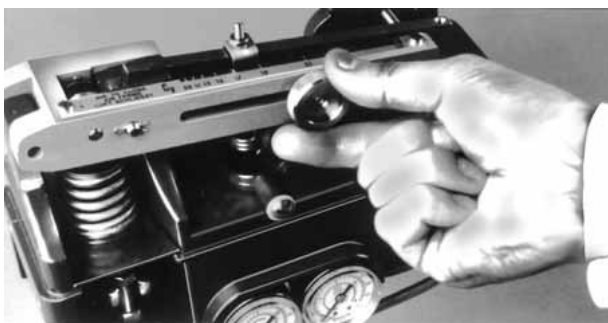
Obrázek 4 - Nastavení C_V ventilu VariPak 28002 pro každou kombinaci kuželky a sedlového kroužku
