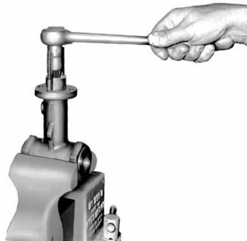
Obrázek 19 - Dotážení zádržného kroužku sedla (4)
