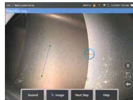
Fig 2b. Ajustez la ligne de sortie au bord de la surface portante
