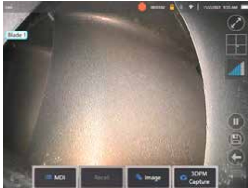
Figure 8a. Compteur de lame actif affichant la zone de texte du numéro de lame.
