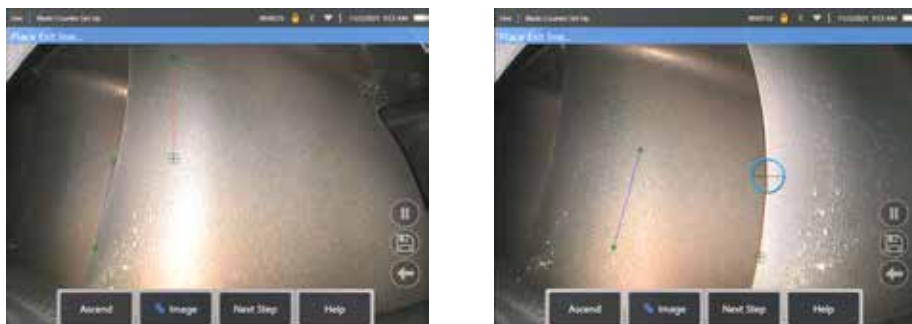
Abb. 2a. Anfangszustand nach Zuordnung der Eingangslinie Abb. 2b. Die Ausgangslinie an die Tragflächenkante anpassen
