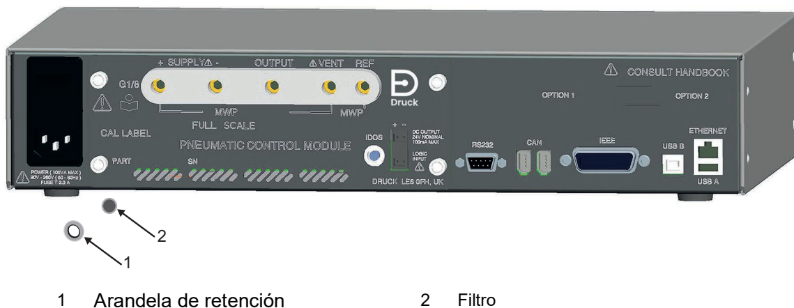
Figura 4-2: Sustitución de los filtros del módulo de control de presión
