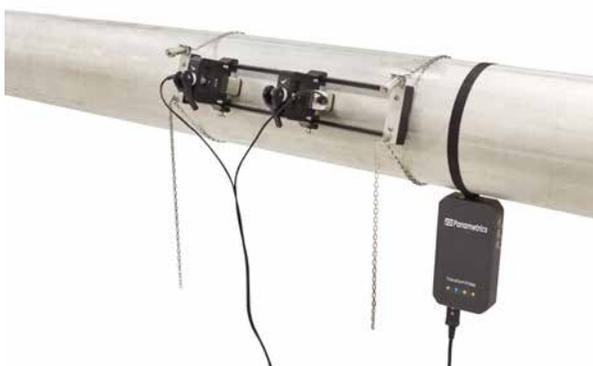
Зажимное устройство, преобразователи и датчик смонтированы на трубопроводе
