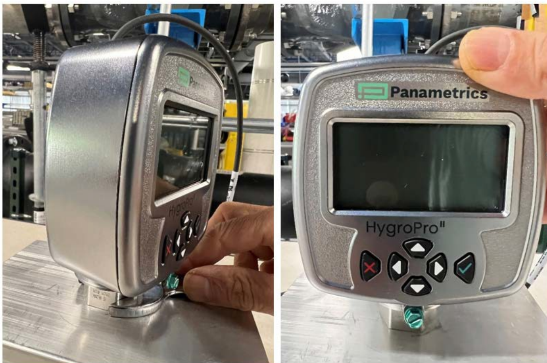
Figure 6 : HygroPro II étape 3 de l'installation – installation dans la cellule d'échantillonnage
