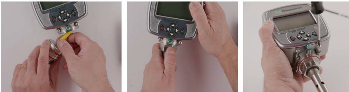
Figure 19: Réinstallation la sonde Hygro II RTE dans le transmetteur démonté
