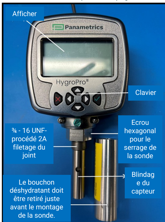
Figure 3 : Clé HygroPro II les pièces pertinentes à l'installation
