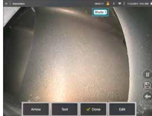
그림 8a. 블레이드 번호 텍스트 상자를 표시하는 블레이드 카운터 활성화. 그림 8b. 조정된 블레이드 번호 텍스트 상자를 표시하는 블레이드 카운터 활성화. 텍스트 상자를 화면의 모든 위치로 이동할 수 있습니다.
