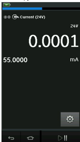
Рисунок 2-17: Измерение тока на канале CH1. Диапазон \pm 55 мА
