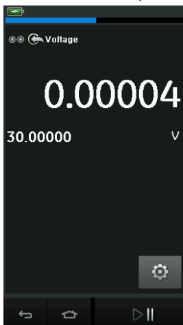
Рисунок 2-18: Измерение напряжения постоянного тока в В или мВ в канале CH1
