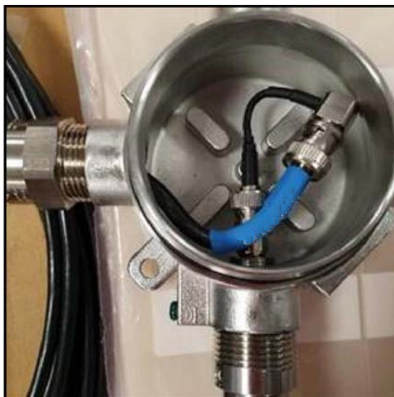
図 18: ケーブルジャンパ付きトランスデューサケーブル接続、PN 133 M 7313-03
