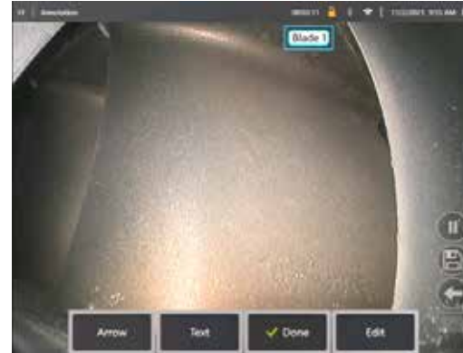
Figuur 8a. Blade Counter actief met weergave van tekstvak aantal schoepen. Figuur 8b. Blade Counter actief met weergave van aangepast tekstvak aantal schoepen.
