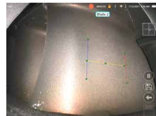
Fig 9c. Blade Counter actief met weergave van oorspronkelijk traceergebied
