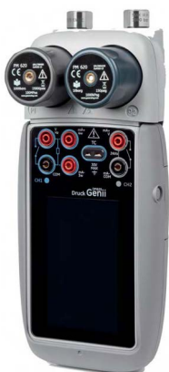
図 1-1: MC 620G モジュールキャリアと PM 620 圧力モジュールを備えた DPI 620 Genii
