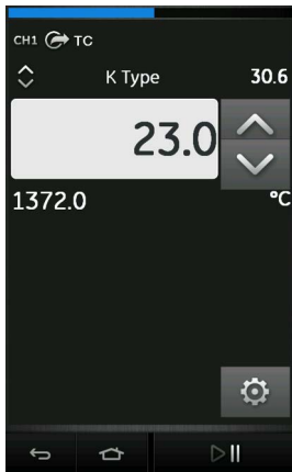
図 4-17: K- タイプ熱電対ソース CH1 ( 範囲 -270 ~ 1372°C )
