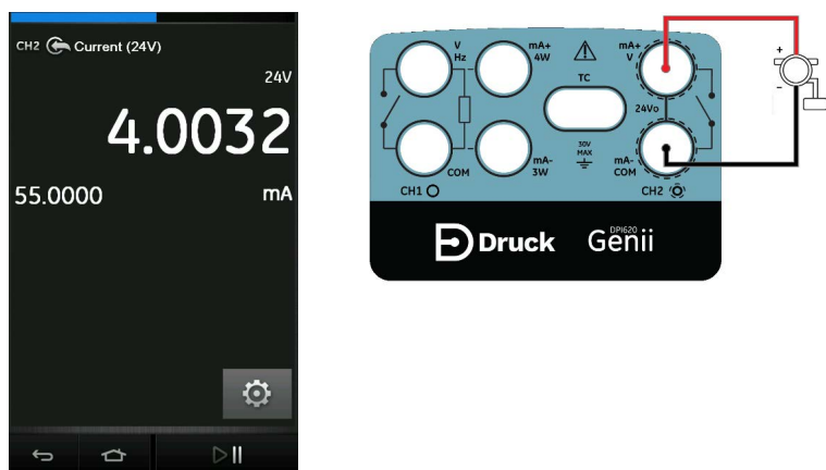
図 4-8: 内部ループパワーによる CH2 の測定電流 (範囲 : 55 mA)
