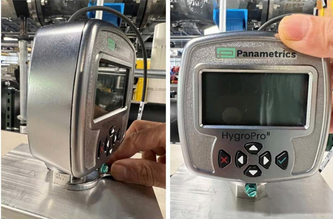
图 6: HygroPro<sup>II</sup> 安装步骤3 - 安装到样品池中
