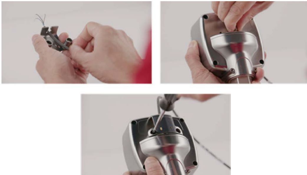
图4： HygroPro II 安装步骤1 - 初始接线
