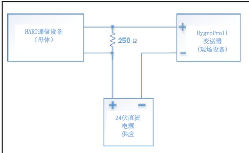
图13: HART 点对点连接, 其中最多 2 个主设备可与HygroPro<sup>II</sup>一起使用
