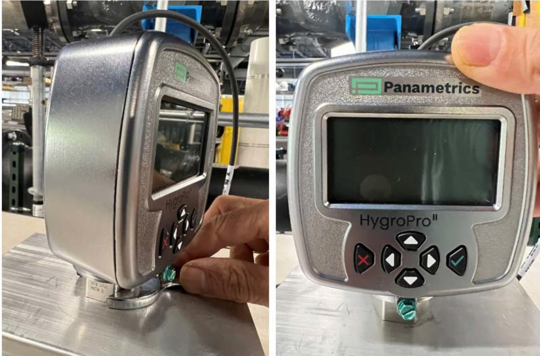
图 6: HygroPro II 安装步骤3 - 安装到样品池中
