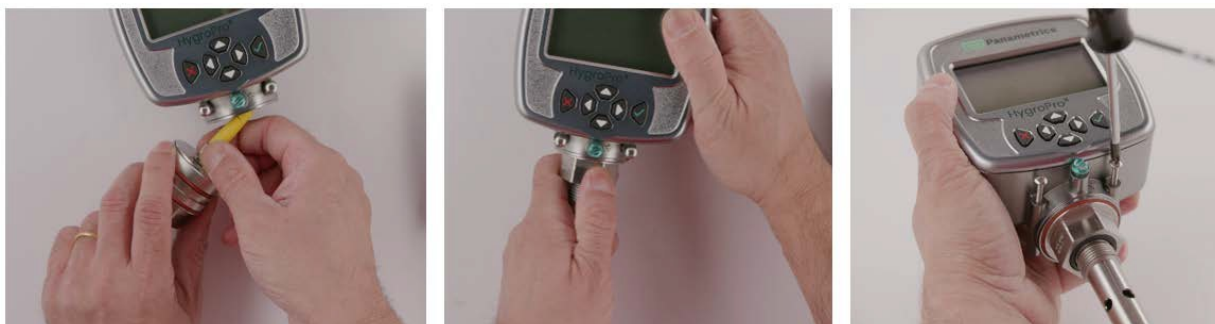
图19: 将 HygroII RTE 探头重新安装到拆下的变送器中
