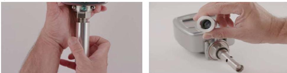
图 5： HygroPro<sup>II</sup> 安装步骤2 - 取下干燥外壳
