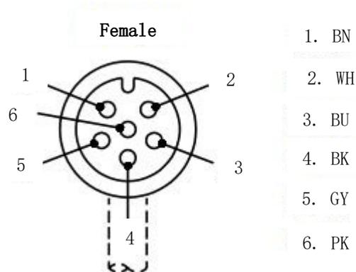
图21: 6 针母头 M8 接头的针脚输出
