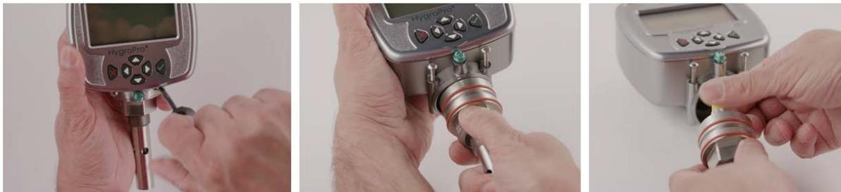
图 17: 从变送器上逐步拆下 HygroII RTE 探头
