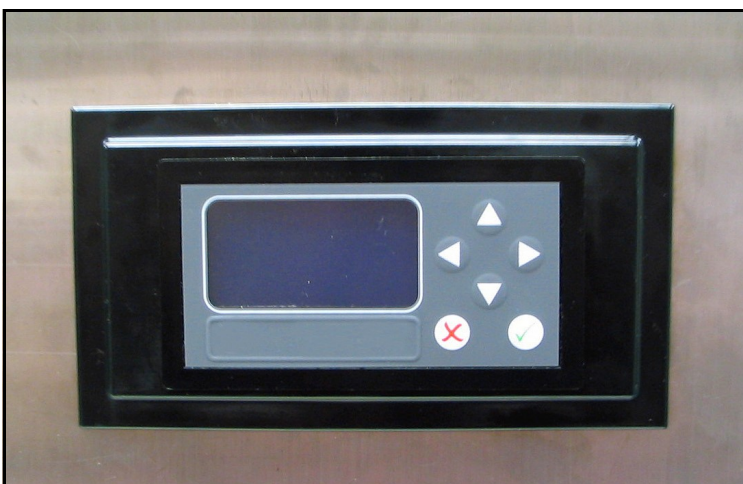
Figura 22: Instalação do higrômetro com placa adaptadora - frontal
