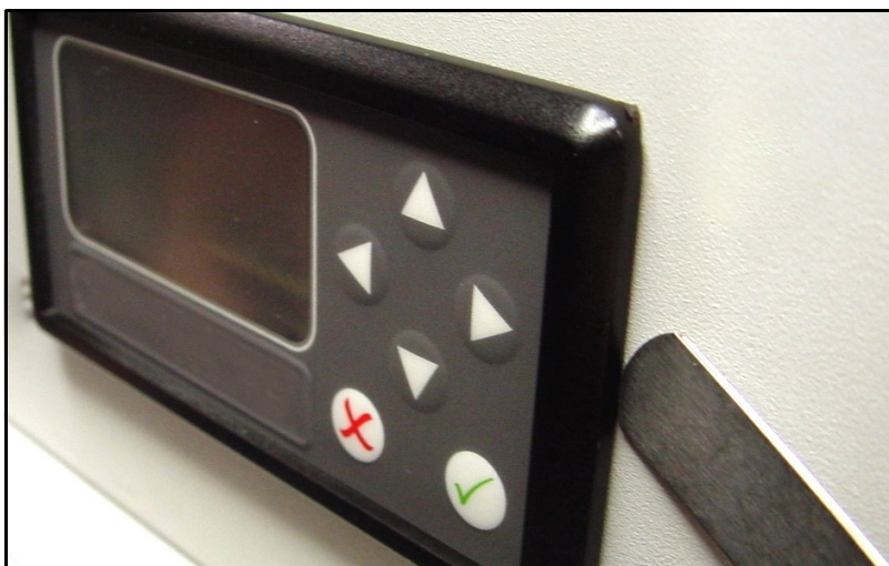
Figura 15: Verificar a compactação da gaxeta
