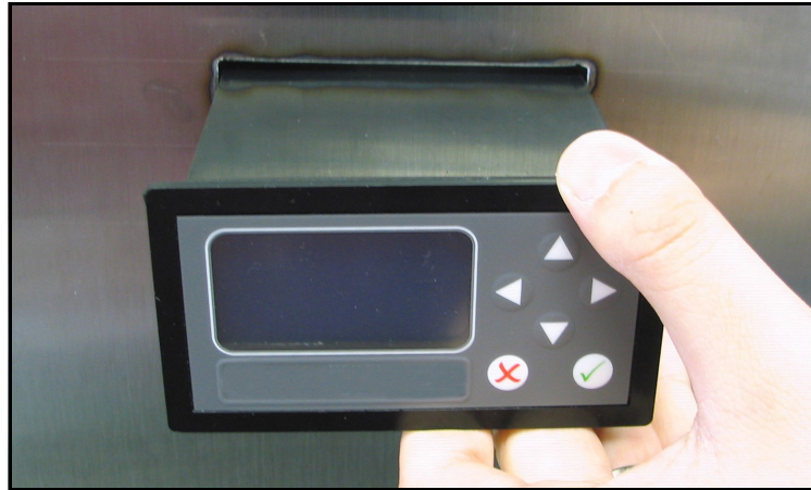
Figura 11: Deslize o higrômetro no corte do painel.
