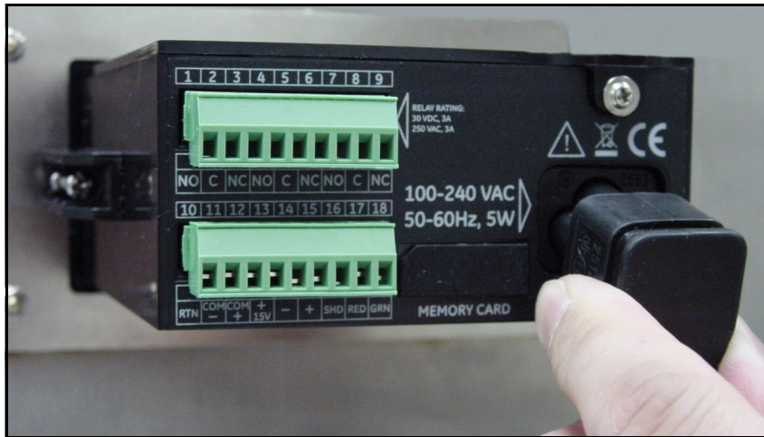
Figura 38: Inserir o cabo de força CA
