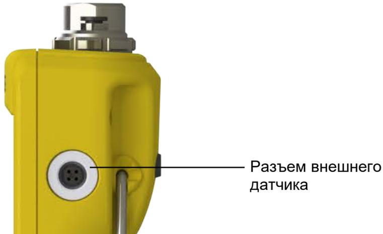
Подключение датчика осуществляется с помощью поставляемого соединительного кабеля (его правильная установка напрямую невозможна). Необходимо вставить разъем (совместив выемку на разъеме и штекере), после чего внешнюю часть корпуса вращать по часовой стрелке, чтобы зафиксировать разъем на месте. Допускается использование нескольких последовательно соединенных кабелей (в качестве удлинителей). При очень большой длине кабельного соединения допускается последовательно соединять не более 10 кабелей.
