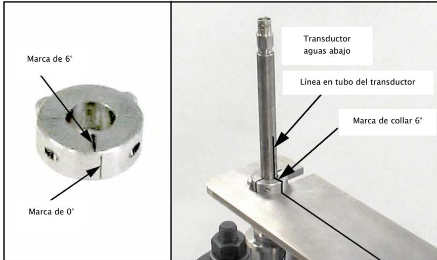
**Figura 11: Instalación del collarín de bloqueo**
