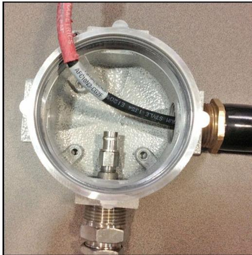
**Figura 18: Transductor y prensaestopas montados**
