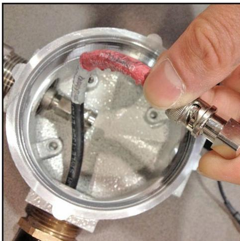
**Figura 19: Conexión del conector BNC al cable**
