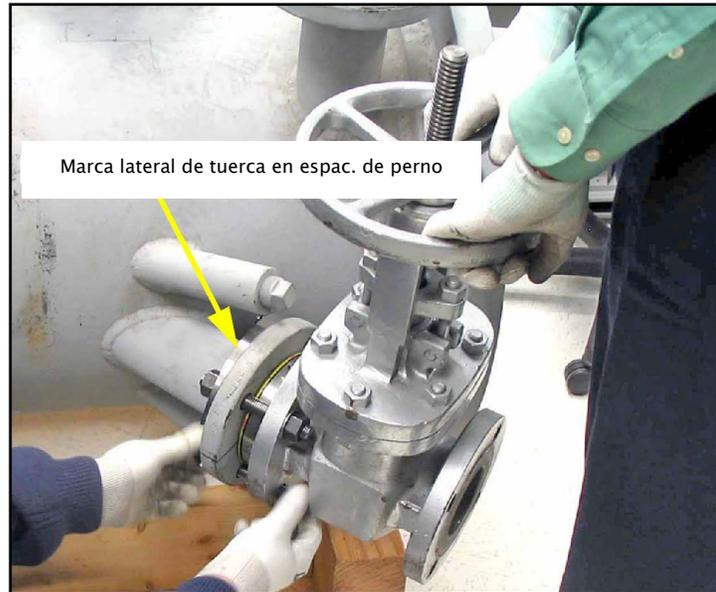
**Figura 5: Montaje de la válvula de aislamiento**
