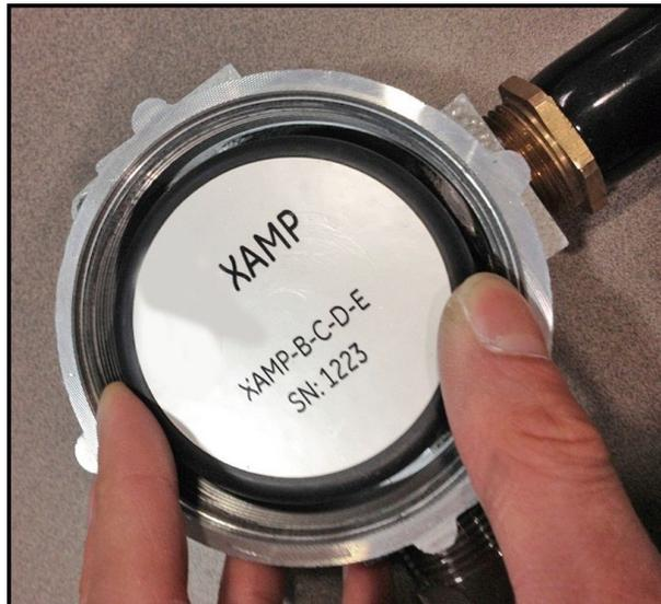
**Figura 22: Tapa de la caja de conexiones**
