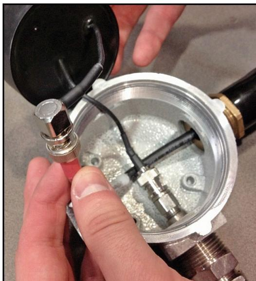
**Figura 20: Conector hembra a cabezal macho BNC**
