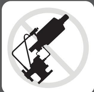
Instale siempre la válvula en posición vertical y recta.
