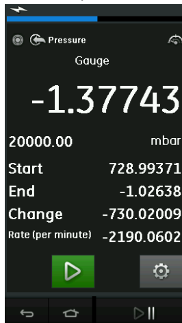
Figura 2-26: Esempio di prova di perdita
