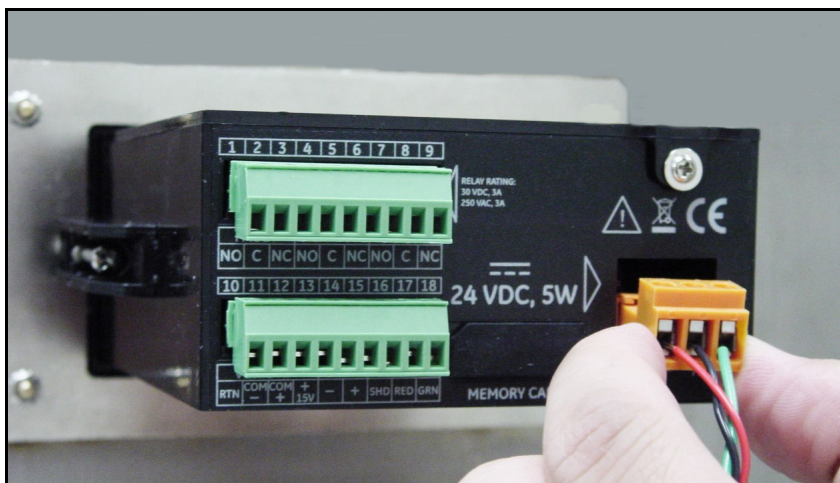
Abbildung 42: Wiederanschließen des Gleichstromsteckers
