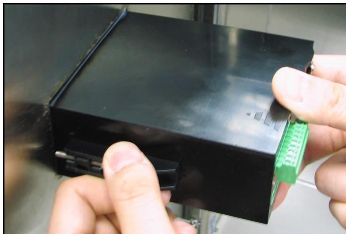
Abbildung 13: Befestigen der Halterungen
