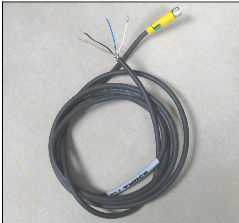
Abbildung 33: Kabel des Feuchtigkeits-Messwandlers
