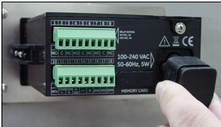
Abbildung 38: Anschließen des Netzkabels
