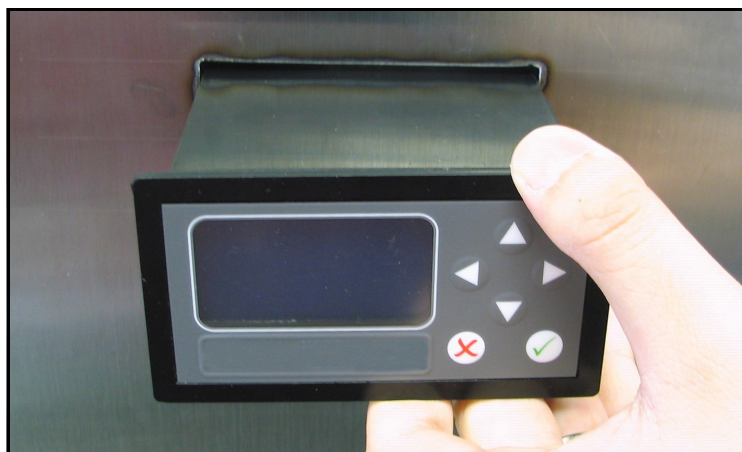
Abbildung 11: Schieben des Hygrometers in den Tafelausschnitt
