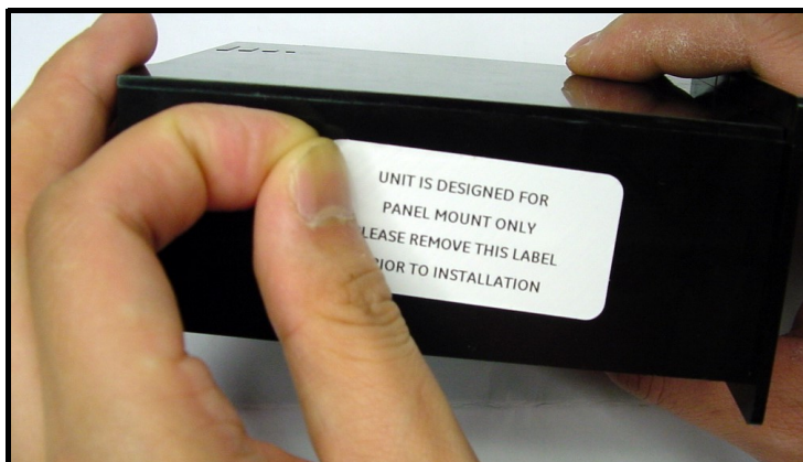
Abbildung 9: Entfernen des seitlichen Aufklebers für die Tafelmontage
