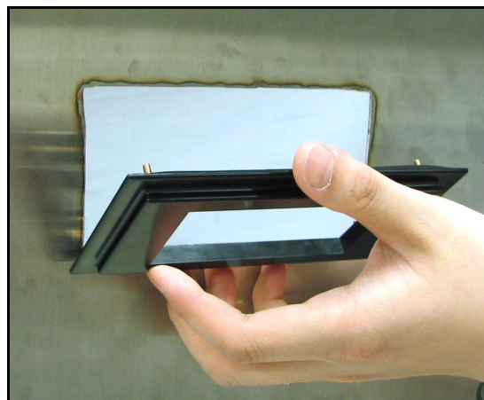
Abbildung 17: Einsetzen der Adapterplatte
