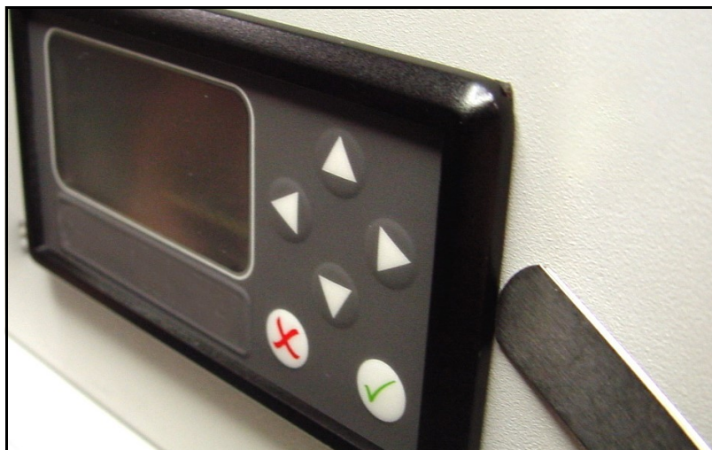
Abbildung 15: Prüfen des Dichtungsandrucks
