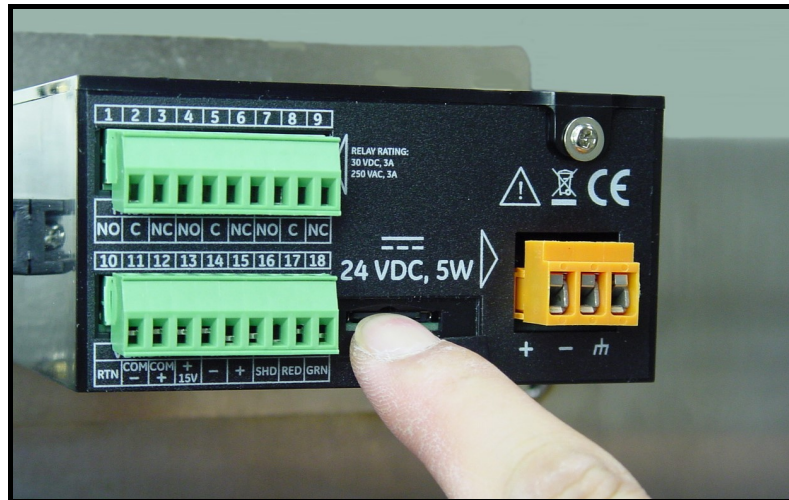
Abbildung 53: Eindrücken der MicroSD-Karte
