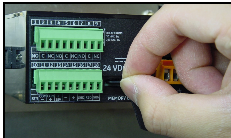
Abbildung 54: Entfernen der MicroSD-Karte
