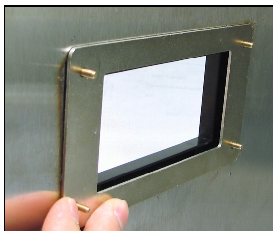
Abbildung 18: Aufsetzen der Trägerplatte
