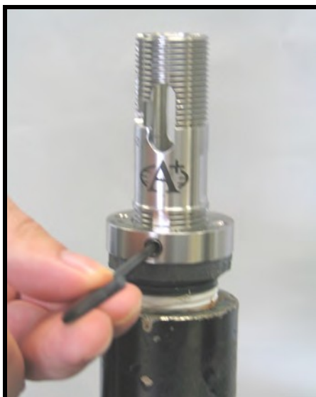
図14：六角穴付きネジの位置調整と締め込み
