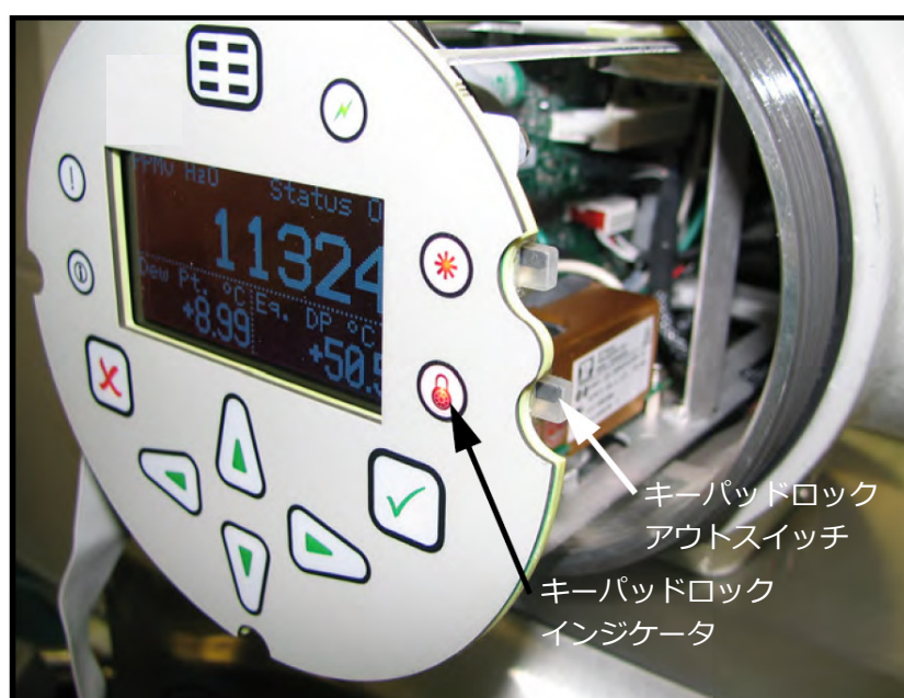
図37 : キーパッドロックアウトスイッチの位置
