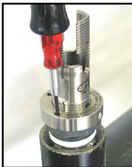
図15：六角穴付きネジの締め込み
