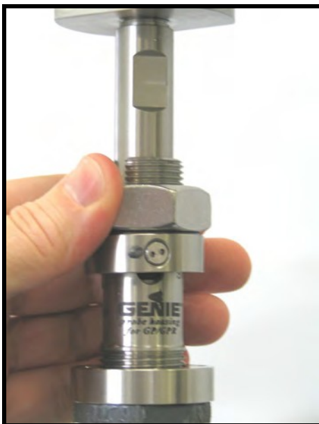
図22：インサートナットの締め込み
