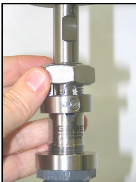
図21：インサートナットを緩める
