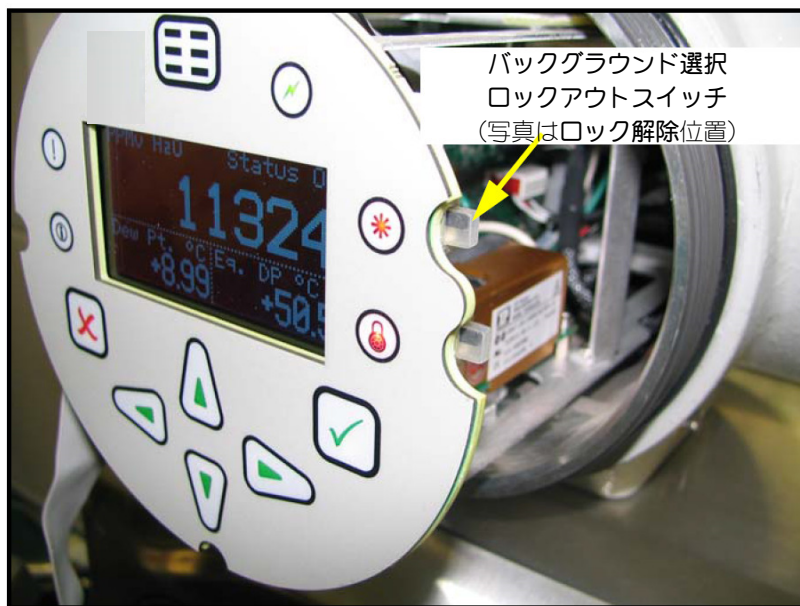
図92 : バックグラウンド選択ロックアウトスイッチの位置
