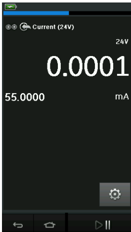
图 2-17: 测量 CH1 上的电流 (量程 \pm 55 mA)
