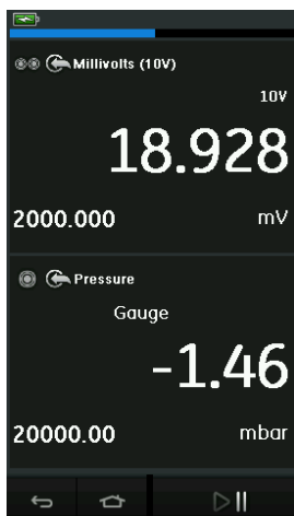
Figura 2-15: Finestra di calibrazione - Vista ridotta
