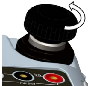
Figura 2-2: Valvola di rilascio della pressione
