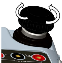
Figura 1-4: Valvola di rilascio della pressione
