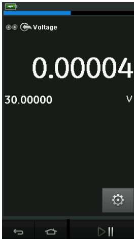
Figura 2-18: Misurazione dei Volt CC o dei mV CC su CH1
