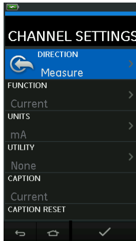
Figura 2-10: Menu Channel Settings (Impostazioni canale)
