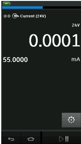
Figura 2-17: Misurazione della corrente su CH1. Campo \pm 55 mA
