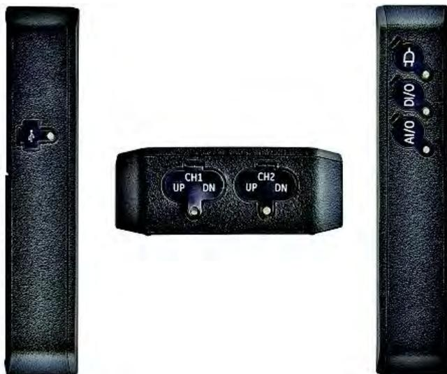
Connessioni elettroniche trasmettitore
