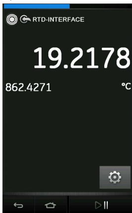
Figura 6-4: Ejemplo: RTD-INTERFACE en el canal del sensor externo
