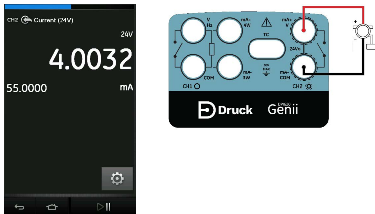
Figura 4-8: Medición de corriente en CH2 con alimentación de circuito interno (rango: 55 mA)
