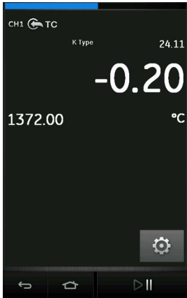
Figura 4-16: Medición de termopar tipo K en CH1 (rango de -270 a 1372 °C)
