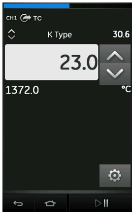
Figura 4-17: Generación de termopar tipo K en CH1 (rango de -270 a 1372 °C)
