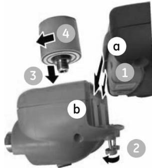
Figura 5-5: Procedimiento de montaje del MC 620G
