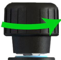
要将系统排气至大气压，请缓慢逆时针旋转压力释放阀，直到传感器读数变为零（仪表传感器）或 1 bar（绝对传感器）。
