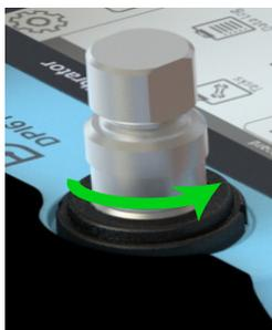
1. 确保堵头密封测试端口。要安装堵头插头，请将插头插入旋转连接器的螺纹中，保持到位，然后逆时针完全旋旋转连接器，直到用手拧紧。
