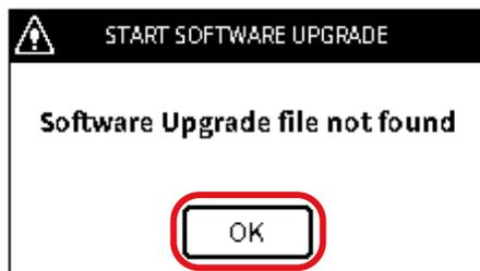
5. 如果屏幕显示“未找到软件升级文件”消息，则系统找不到文件“DK0492.raw”。该文件必须位于仪器的根目录中，才能找到它。请参阅本节开头的说明，了解如何将此文件的副本放入内存中。选择“确定”按钮以关闭此屏幕消息。如果您无法将软件更改为新版本，请联系技术支持部门以获取说明（请参阅第 1 章）。
