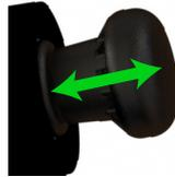
19. 连接待测设备后，如果在步骤 17f 的第一部分完成，逆时针旋转体积调节器约转数的一半，同时缓慢推动启动泵以保持流体压力在 10-15 bar 之间，这仅适用于用户使用步骤 17f 连接设备。否则，使用注油泵将流体压力保持在 10-15 bar 之间。
