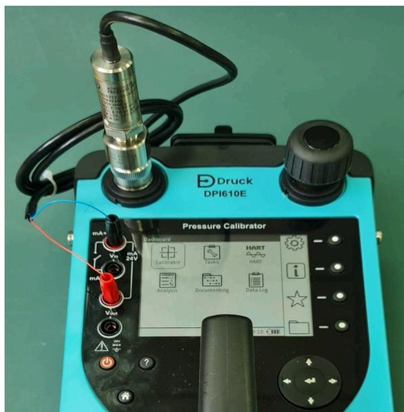
如果压力连接器螺纹与 DPI610E Test Port 快速接头连接器不同，请使用适用的适配器接头。适配器配件的额定电压必须为 35 barg。使用中的第 20 页的第 2.1.5 节“连接受测设备”步骤将 ADROIT 传感器连接到测试端口。
