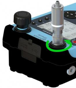
5. 要将被测设备连接到测试端口或集尘器，请将设备放在插座中，然后逆时针完全转动连接器底部的旋转连接器，直到用手拧紧。确保被测设备具有 G 3/8 外螺纹 Quickfit 适配器螺纹或使用额定压力为 35 bar 的合适适配器。如有疑问，请联系我们的服务和支持 - 请参阅背面。
