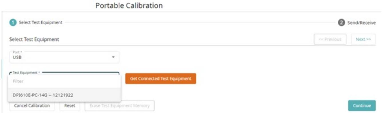
**注：**如果在连接到 DPI610E 时发生错误，请确保 DPI610E 已插入并处于虚拟通信端口（VCP）模式。如果 Druck 通信服务器未安装且未运行，则无法进行连接。
