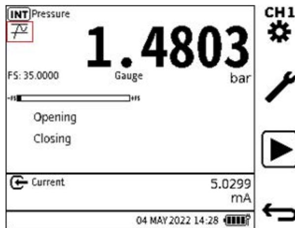
3. 校准器屏幕将设置**安全阀**测试数据。**CH1** 窗口将自动变大以显示测试数据。
