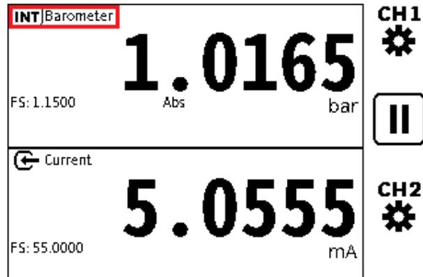
5. 确保在所需的通道窗口中正确设置了气压计功能。
