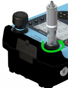
要将被测设备连接到测试端口或集尘器，请将集尘器放入旋转连接器的螺纹中，然后逆时针完全旋转旋转连接器，直到用手拧紧。
