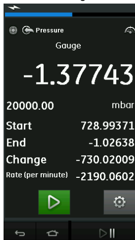
Figura 2-26: Ejemplo de la prueba de fuga
