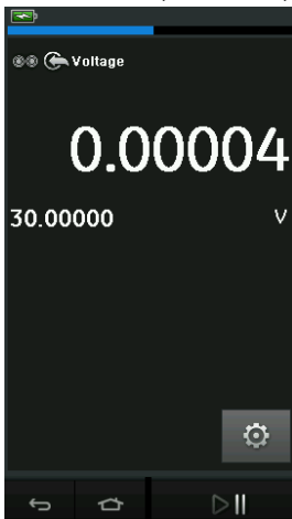
Afbeelding 2-18: Meet VDC of mVDC op CH1.
