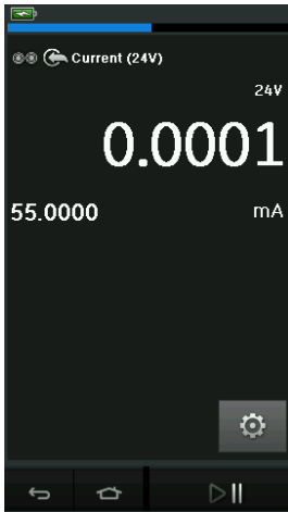
Afbeelding 2-17: Stroom op CH1 meten. Bereik \pm 55 mA
