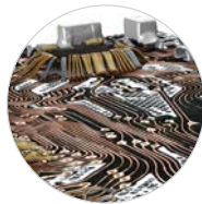
Tomografía computarizada 3D de una unidad flash USB
