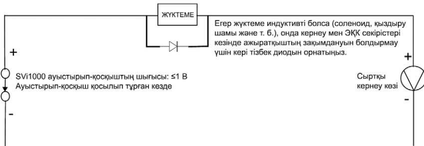
33-сурет — Ауыстырып-қосқыштың оңайлатылған монтаждық сызбасы: Дұрыс конфигурация.
