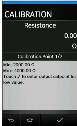
图 12-9: 校验 — 电阻输出 CH1 (量程: 2000 至 4000 Ω)
