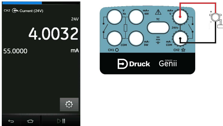
图 4-8：使用内部回路电源在 CH2 上测量电流（最大测量值：55 mA）
