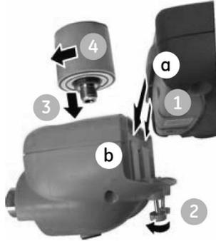
**Figure 5-5 : Procédure d'assemblage du MC 620G**
