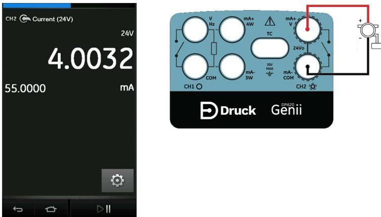
Figure 4-8 : Mesure de courant sur CH2 avec boucle d'alimentation interne (page : 55 mA)
