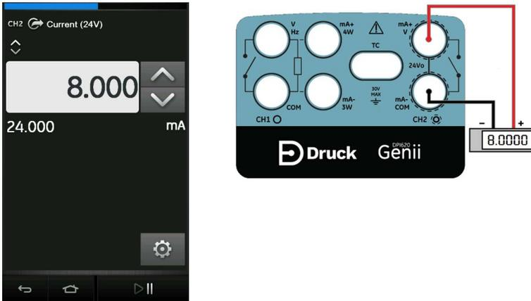
Figure 4-7 : Génération de courant sur CH2 avec boucle d'alimentation interne (page : 0 à 24 mA)
