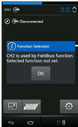
**Figure 11-1 : Fonction CH2 verrouillée lorsque Profibus® est activé**
