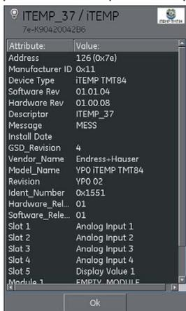
**Figure 11-10 : Profil d'appareil Profibus®**
