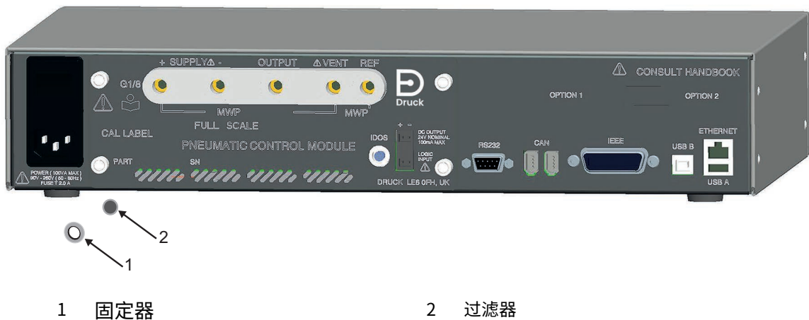
图 4-2: 更换压力控制模块过滤器
