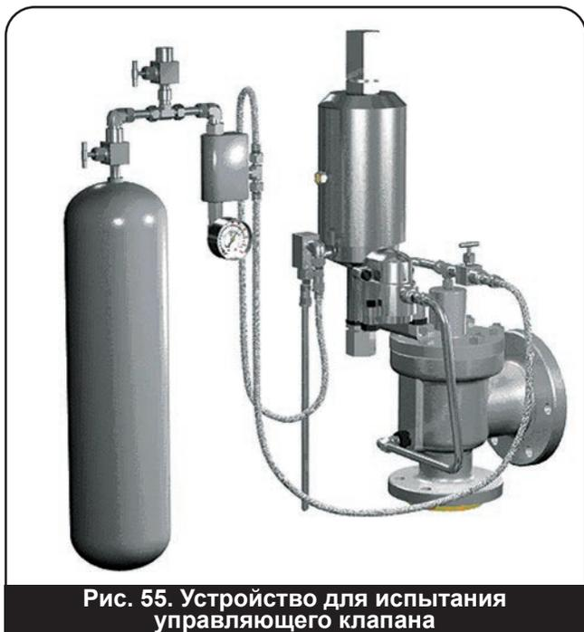
Рис. 55. Устройство для испытания управляющего клапана
