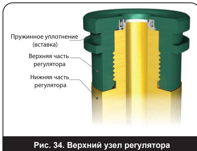
Рис. 34. Верхний узел регулятора
