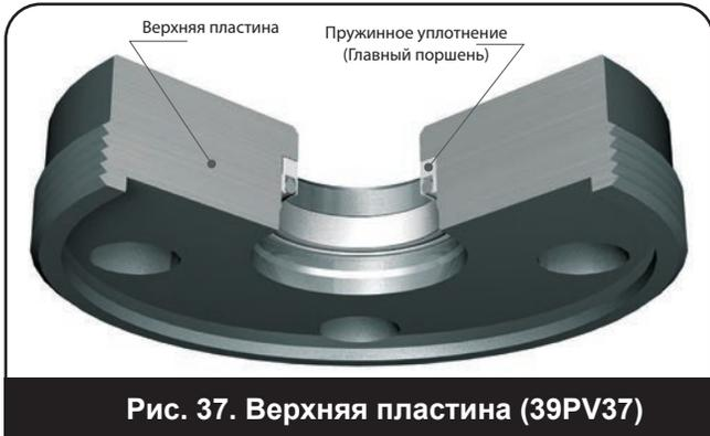
Рис. 37. Верхняя пластина (39PV37)
