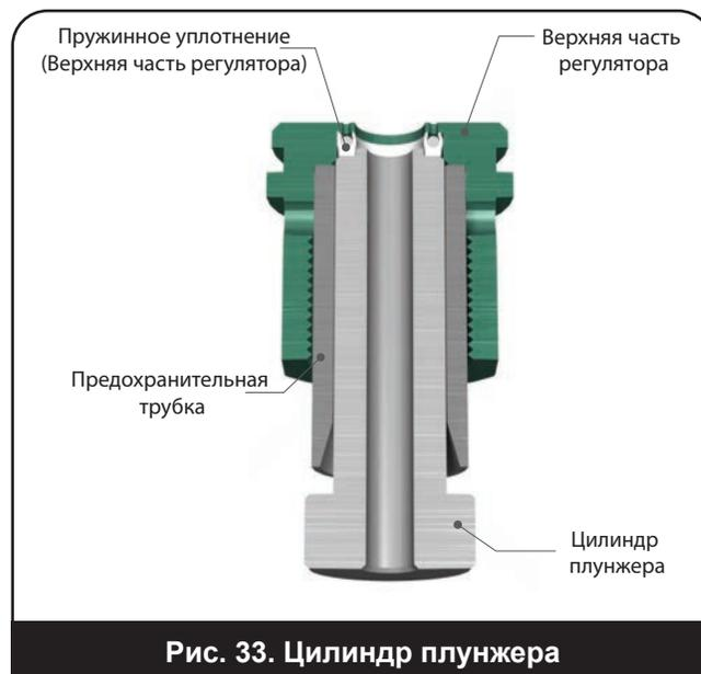
Рис. 33. Цилиндр плунжера
