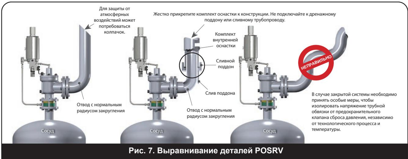
чтобы предотвратить создание напряжений на клапане от теплового расширения. Выпускной трубопровод должен быть спроектирован с учетом расширения сосуда, равно как и расширения самой выпускной трубы. Это особенно важно на протяженных трубопроводах.
