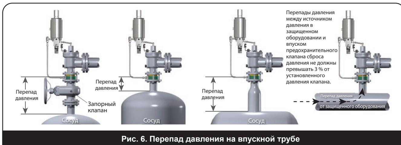
Рис. 6. Перепад давления на впускной трубе
