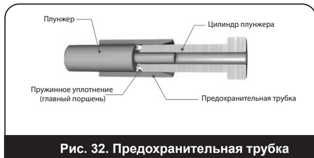
Рис. 32. Предохранительная трубка
