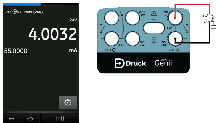
Figura 4-8: Misurazione della corrente su CH2 con alimentazione a circuito interno (range: 55 mA)
