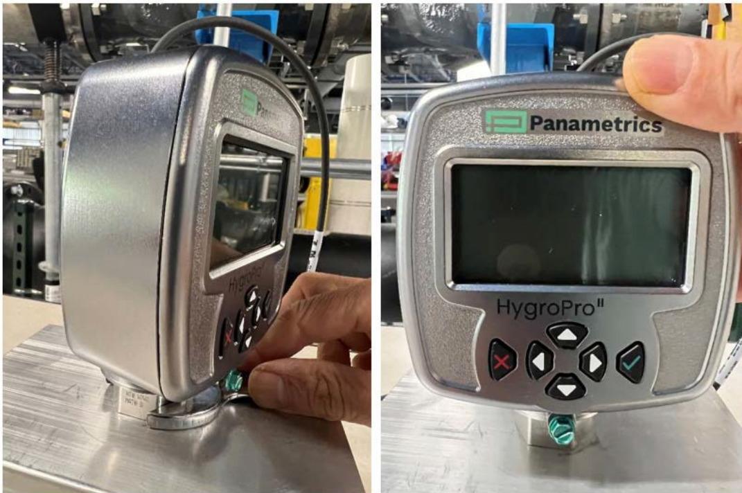
Figura 6: HygroPro II instalación paso 3 – instalación en la célula de muestra
