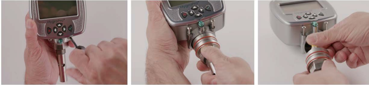
Figura 17: Extracción paso a paso de la sonda Hygro II RTE del transmisor
