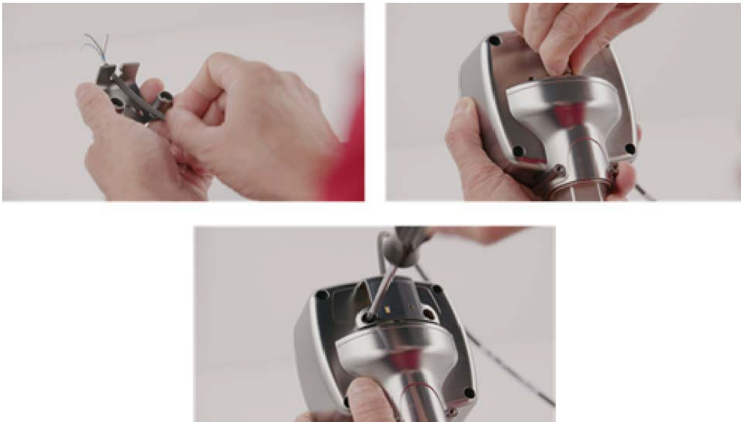
Figura 4: HygroPro II instalación paso 1 – cableado inicial
