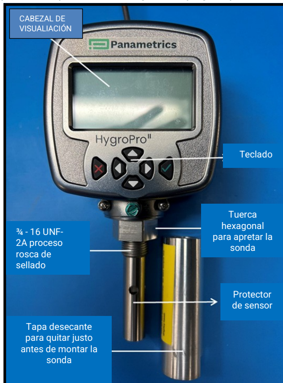
Figura 3: Partes de la llave HygroPro II importantes para la instalación.
