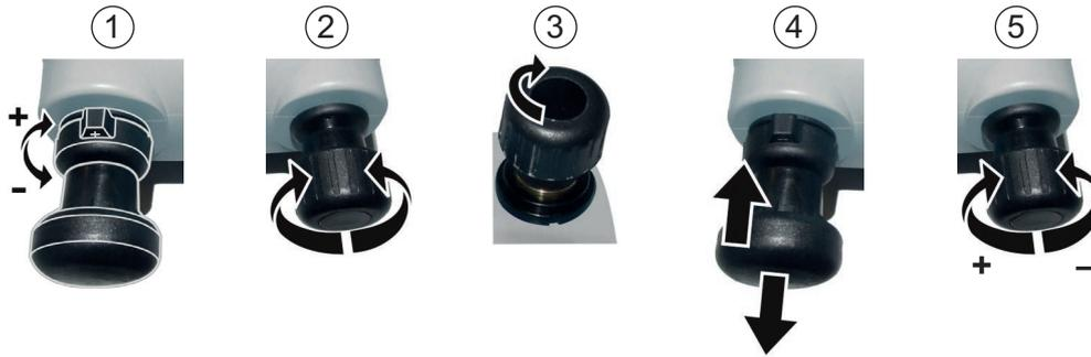
1. Sitúe el selector de presión/vacío en la posición de presión (+); totalmente a la derecha.
