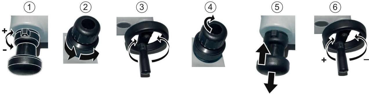
1. Sitúe el selector de presión/vacío en la posición de vacío (-); totalmente a la izquierda.
