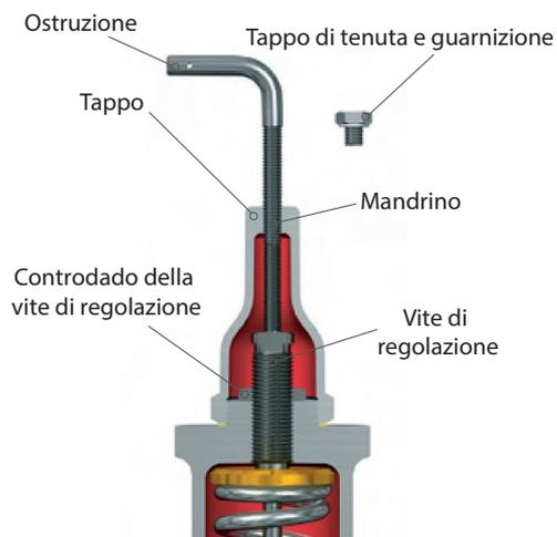
Figura 41: Test idrostatico
