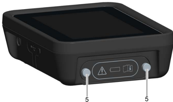
Figur 4: Batterirom på ADTSTOUCH
