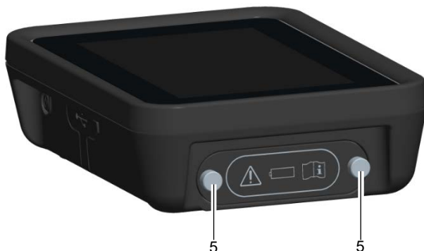
Figur 4: Batterirum i ADTSTOUCH
