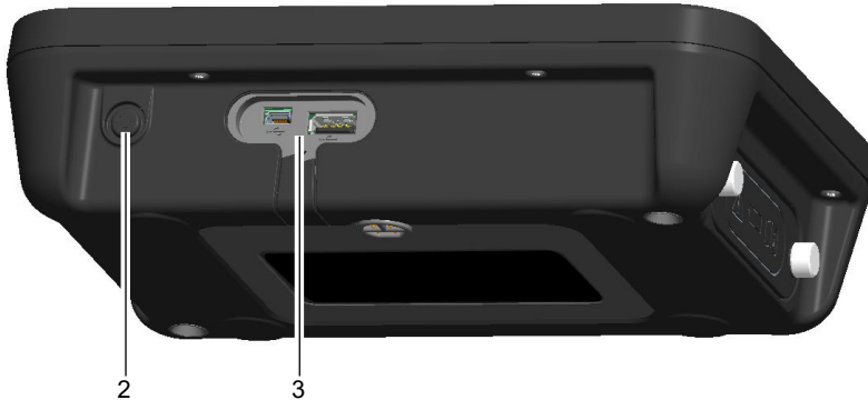
Figur 2: På/av-bryter og USB-kontakter for ADTSTOUCH
