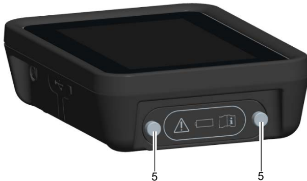
Figura 4: Vano batteria ADTSTOUCH
