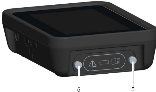
Abbildung 4: Batteriefach des ADTSTOUCH
