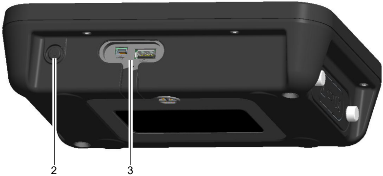
Figura 2: Interruptor de apagado/encendido y conectores USB
