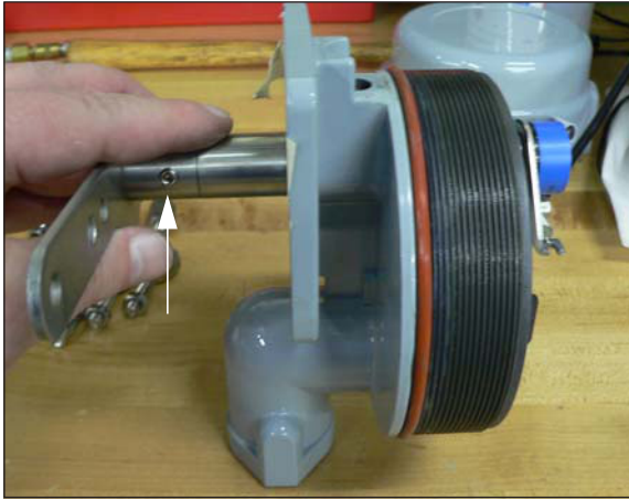
그림6 RPS 조립부에 레버 암 부착하기
