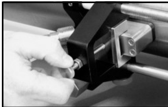
Figura 27: Instalación del primer transductor
