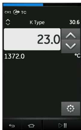
Рисунок 4-17: Источник термопары типа К на канале CH1 (диапазон от –270 до 1372 °С)
