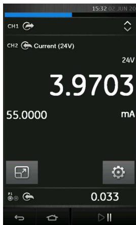
Рисунок 3-2: Окно устройства калибровки. Развернутый вид канала CH2
