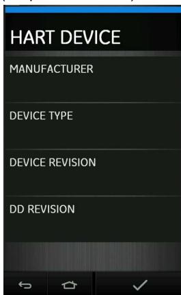
Рисунок 9-15: Автономный режим HART®. Создание новой конфигурации HART®
