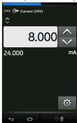
Рисунок 4-7: Источник тока на канале CH2 с питанием от внутреннего контура (диапазон: от 0 до 24 мА)
