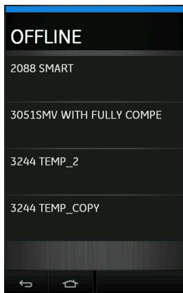
Рисунок 9-18: Автономный режим HART®. Выбор сохраненных файлов конфигурации
