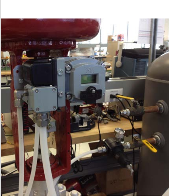
Şekil 68 - Adım 1 3/4" x 3/4" Bağlantı Elemanının Takılması
