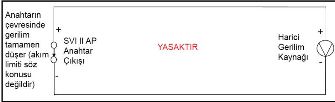
Şekil 49 - Yüksüz Anahtar Kurulum Çizimi: Yapılandırmaya İzin Verilmiyor
