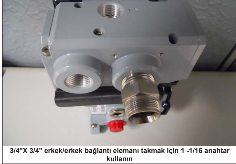
Şekil 68 - Adım 1 3/4" x 3/4" Bağlantı Elemanının Takılması
