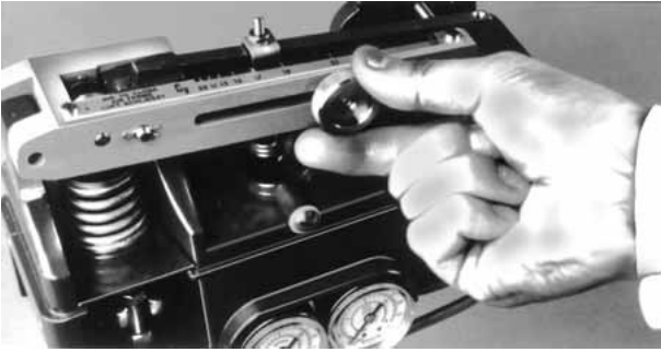
Şekil 4 - VariPak 28002 Valfın C_v değerinin her bir tapa ve yuva halkası kombinasyonu için ayarlanması
