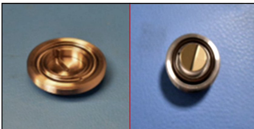
Rysunek 96: Umieszczanie wyczyszczonego lustra w zespole obsadki
