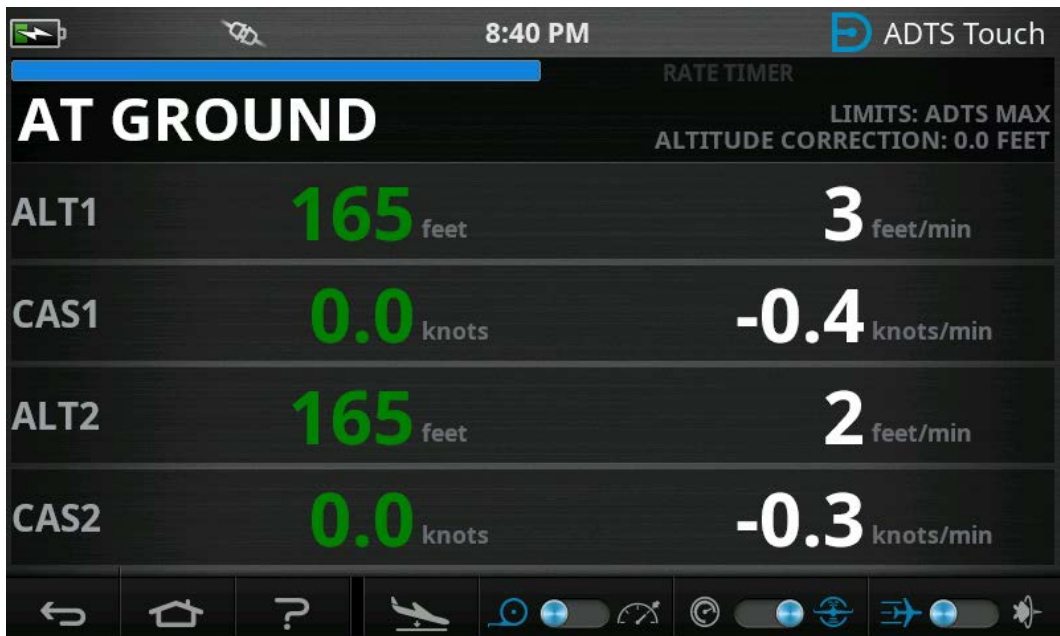
Figura 3-27: Ir a tierra completo – Multicanal
