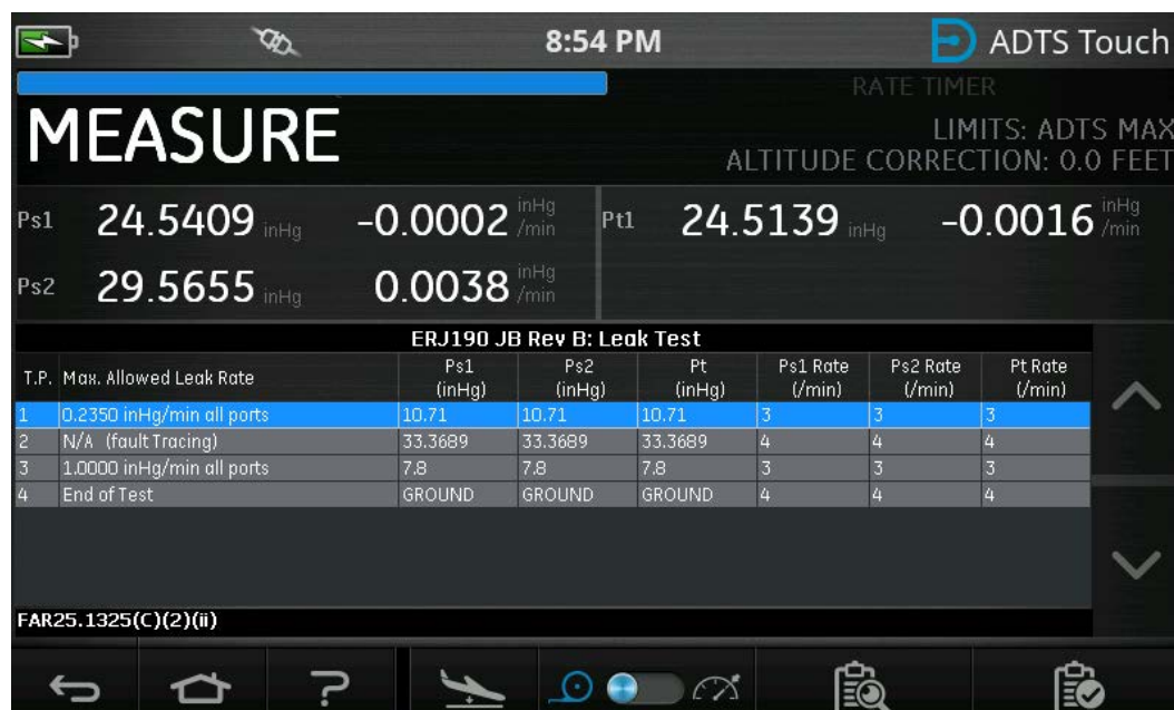
Figura 3-49: Modo de medición de secuencia de pruebas
