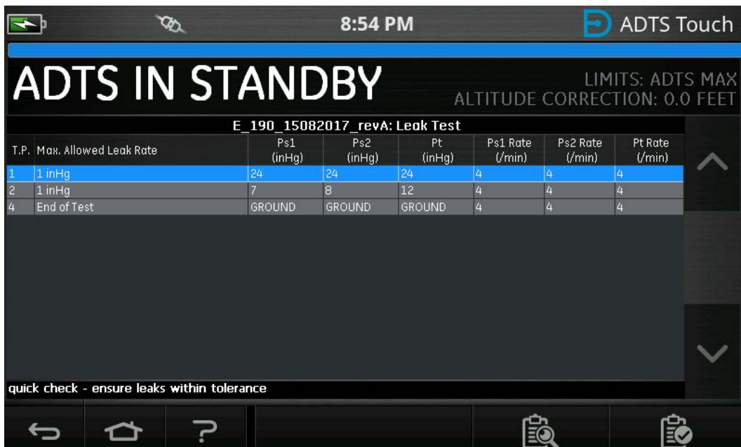
Figura 3-44: Vista de secuencia de pruebas
