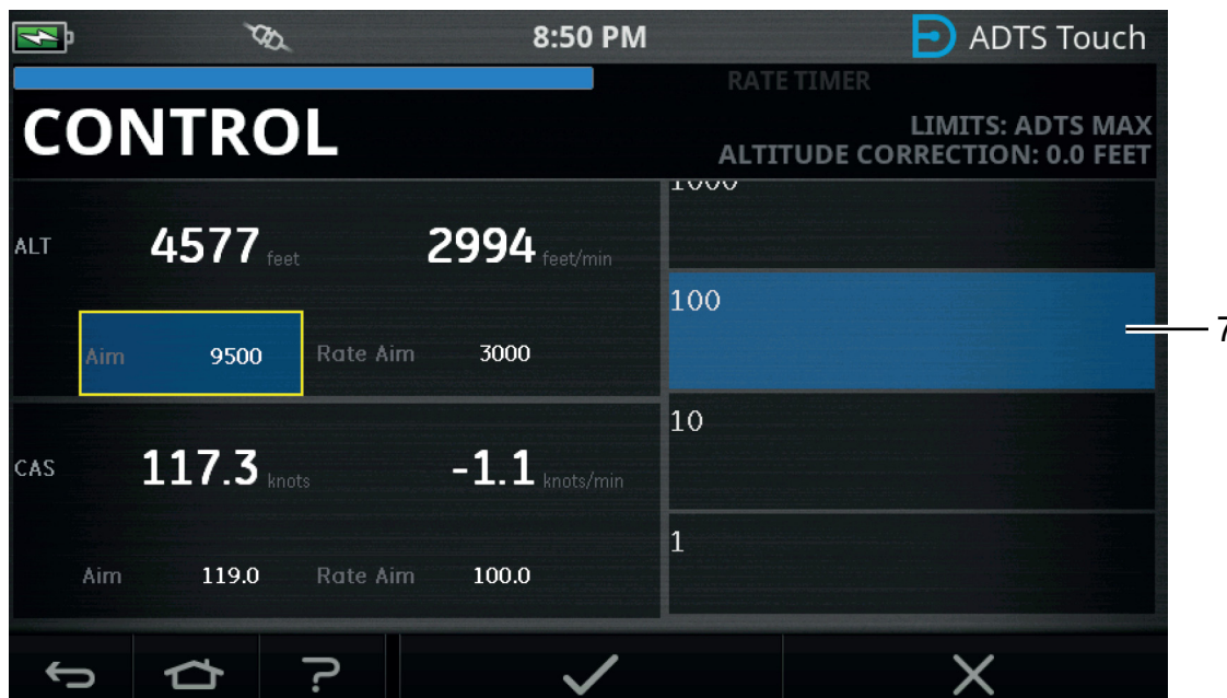
Figura 3-10: Selección de factores de incremento/disminución de empuje
