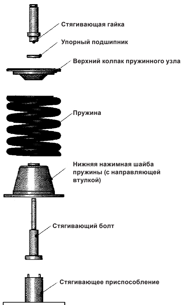
Рисунок 20 – Позиционирование центральных болтов
