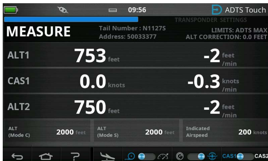
図 B-7: トランスポンダー測定スクリーン
