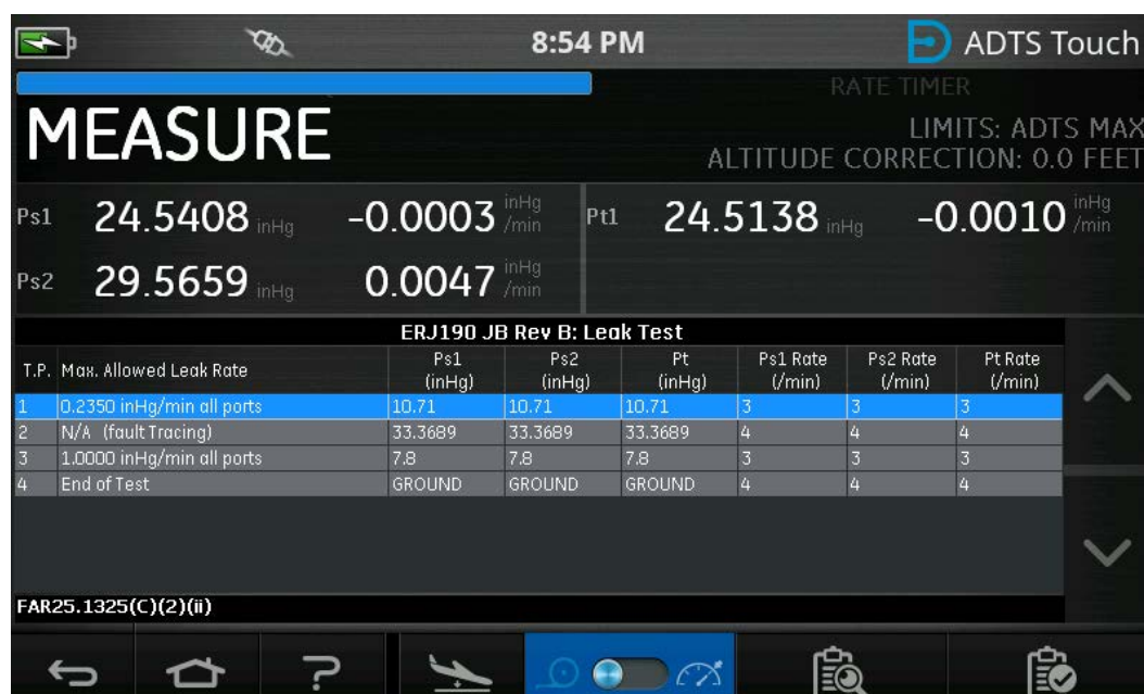
Figure 3-50 : Activation du mode de contrôle
