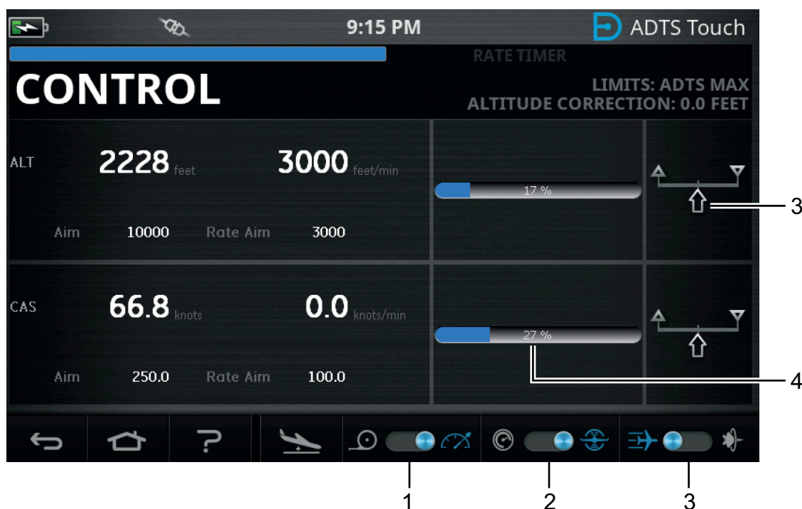
Figure 3-7 : Mode de contrôle – Canal unique
