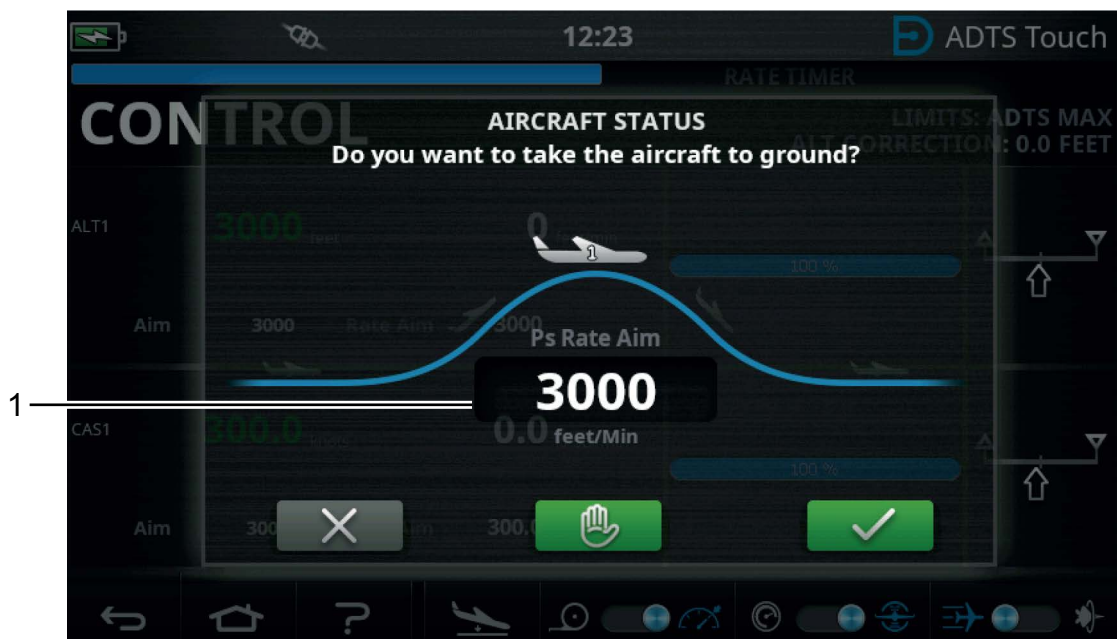
Figure 3-18 : Passer à l'écran principal de la terre – Canal unique
