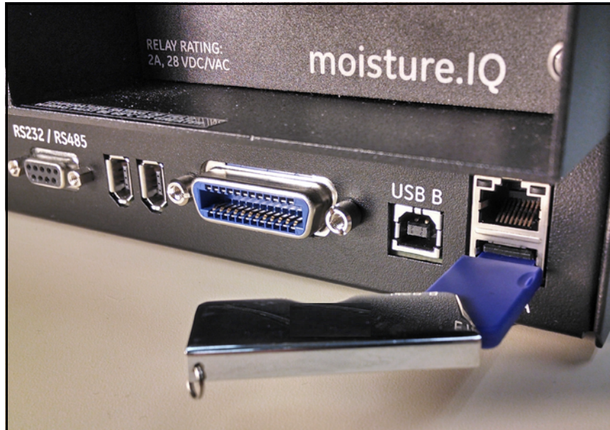
Figura 84: Drive USB flash inserito nel retro del telaio
